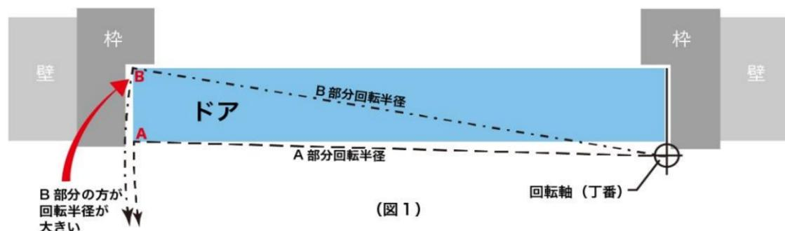
2 地震によって枠が変形(面内変形/局部変形)を起こすことで枠と扉が接触し、扉が開閉困難な状態になります。さらにB部分の回転半径はA部分よりも外側な為、開閉の際は枠を押し広げる力も必要です。
